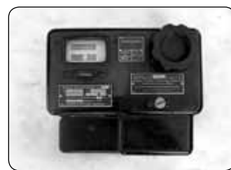
Elektroměr Landis & Gyr na mince z roku 1931. Mince se vsunula shora do otočného knoflíku (vpravo nahoře) a jeho přetočením propadla do kasičky (vpravo dole). Současně se natáhl odměřovací mechanismus, sepnuly se kontakty, přivádějí elektřinu a na dolním počítadle elektroměru se započítala vhozená mince.
