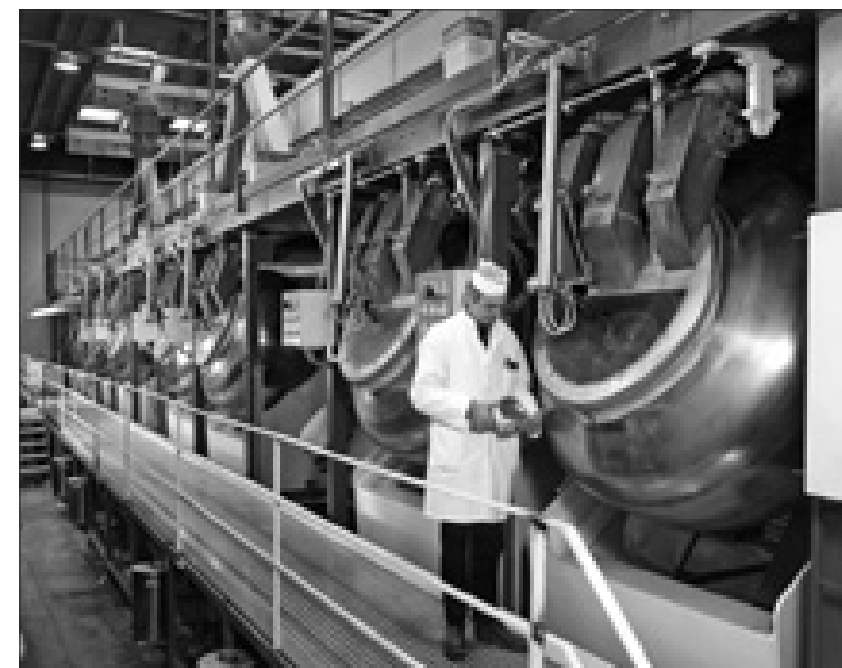
Dražírovací linka s osmi dražírovacími bubny à 300 kg charge na výrobu čokoládových lentilek se stříkovacím, sušicím, nakládacím a vykládacím zařízením
