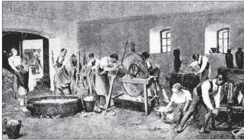
Obrázky jsou z Listů cukrovarnických 1898 a jsou na nich vidět primitivní postupy v prvních cukrovarech. Podobně se vyrábělo i v chlumecké cukerní „dílnič“. Řepa se ručně vyprala, nakrouhala na ruční krouhače a z rozkrouhané řepy lisovala šťáva. Takový postup zaměstnal hodně lidí
