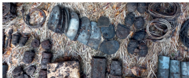
❑ Snímek ukazuje možný vzhled výbušniny (v tomto případě sabotážní) Nipolit. Různě tvarované válečky a např. i náhradní podrážky k botám. Fotografie je pořízena příslušníky Pyrotechnické služby PČR.
