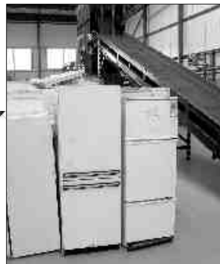
Lednice se nejdříve odborně zbaví nebezpečných freonů a olejů a pak putují do zařízení, které oddělí kov a plasty k dalšímu využití
