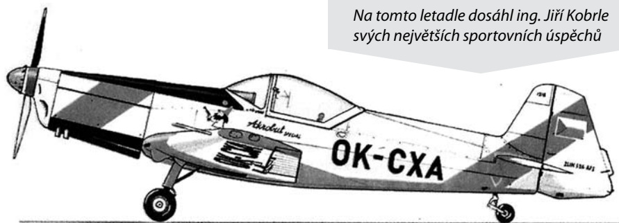
ROZPĚTÍ 8,83 m, DÉLKA 7,8 m, HMOTNOST PRÁZDNÉHO LETOUNU 604 kg, MOTOR M 137 o výkonu 132 kW (180 k), MAX. RÝCHLOST 252 km/hod., DOSTUP -, DOLET 780 km.
