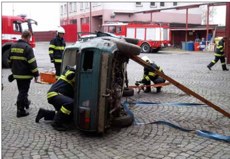
Příslužba na HZS Jičín. Cvičení ve vyprošťování z havarovaných vozidel. Stabilizace vozu na boku pomocí žebříků.
