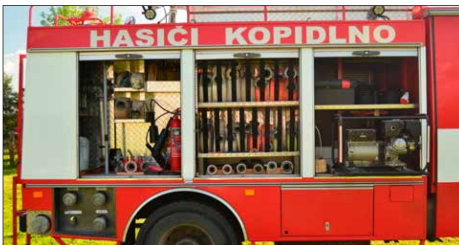
Vybavení vozidla pro požáry. Zleva: a) armatury a hasičí přístroje, b) hadice a proudnice, c) elektrocentrála, kabeláž a osvětlení.
