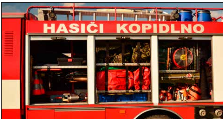
Vybavení vozidla pro dopravní nehody a technické zásahy. Zleva: a) plovoucí čerpadlo, dopravní kužely, hydraulické vyprošťovací nářadí, absorpční prostředky pro uniklé provozní kapaliny, b) v horní části lezecké prostředky, uprostřed fixační prostředky a vakuové dlahy, dole klíny a prostředky pro stabilizaci havarovaných vozidel, c) nahoře brodivé holiny a přetlakový ventilátor, dole motorové pily s příslušenstvím a vysavač hmyzu.
