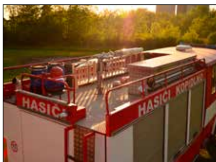
Pohled na nástavbu vozidla Liaz, kde se nachází absorpční prostředky, žebříky a prostředky pro úklid (lpaty, košťata atd.).
