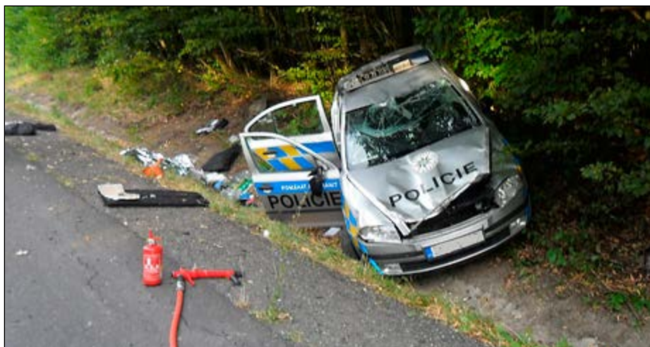
Protipožární zabezpečení místa nehody pomocí vysokotlakého proudu a hasičího přístroje.
