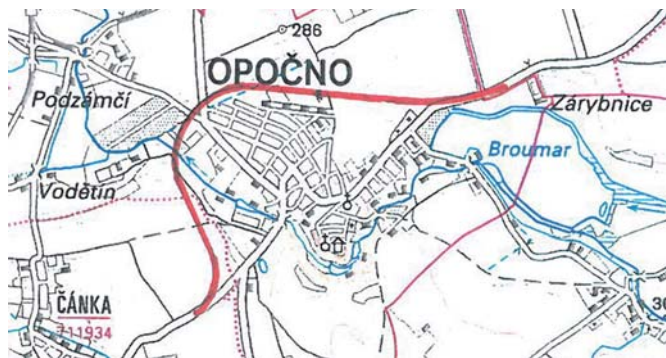
Situační nákres ukazuje předpokládanou trasu obchvatu. I. etapa výstavby by měla řešit část od Jordánku po napojení na silnici na Dobrušku. zdroj: MěÚ Opočno
