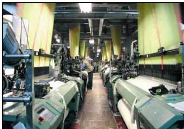
Tkalcovské člunky dnes nahradila stokrát rychlejší vzduchová tryska a řízení stavu převzaly počítače.
