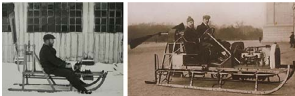
Motorové saně F. X. Welse s tlačnou vrtulí – Wels a Etrich pózuji na saních x-té generace.
