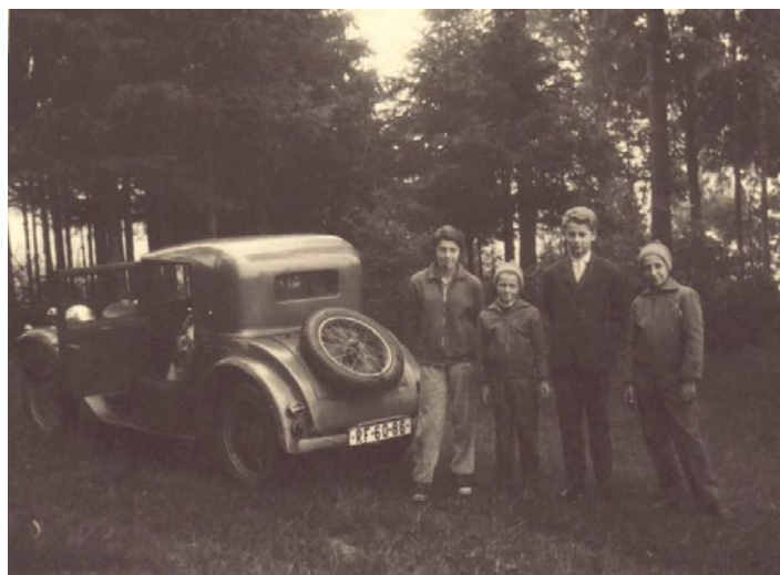
Malé Aero 662 si nechal individuálně upravit majitel fotoateliéru z Nové Paky František Hák. Pod víkem s rezervním kolem se skrývá provizorní sedátko pro spolujezdce.
