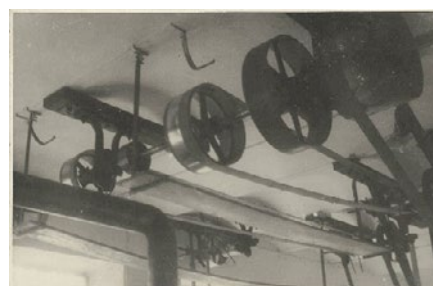
Budova truhlárny v polovině 20. stol. / Demolice staré podlahy / Transmise odřezával autogenem klempíř Josef Vít / Řemenový pohon přes transmise
