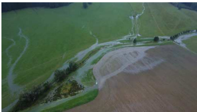
Fotografie pořízená dne 15. 9. 2024 v 16:22 z dronu, minimálně 10 hodin po kulminaci vod. I po postupném opadání vody je vidět soustředěné dráhy odtoku vody z pastviny, lesa, dalšího potůčku a polí, co se týče povrchového stoku. Oblast je však kompletně meliorována, takže meliorační hlavníky dotují jak hlavní přítok, minimálně jeden je zaveden přímo do rybníka, a ještě voda vytéká na pole či do luk z prasklých melio trubek. Vidíme tedy, že přítoky do rybníka jsou vždy z mnoha míst, nejen z údolnice, kde je vybudovaná kaskáda.
