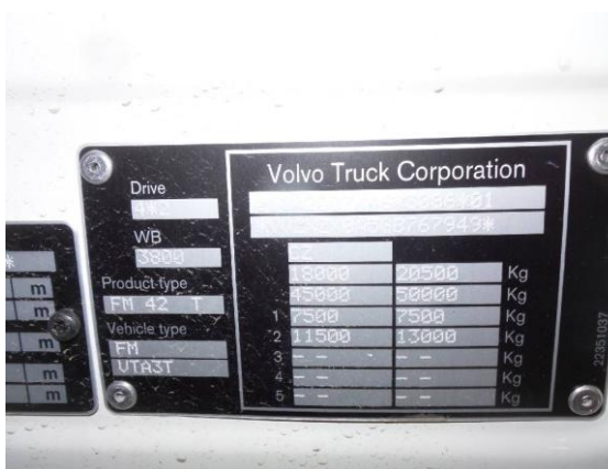
Snímek je přesvícen bleskem, což znemožňuje identifikaci schválení a identifikačního čísla vozidla
