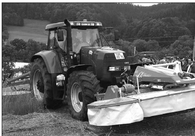
Novinka od firmy Pöttinger, kombinovaná žací lišta NOVOCAT 306F \alpha -motion, dobře kopíruje terén
