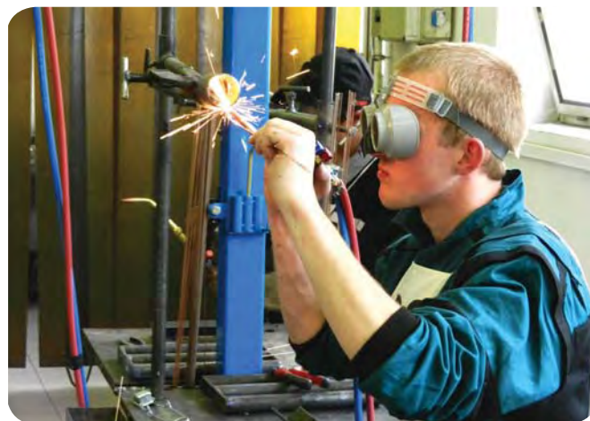
Svařování plamenem – metodou ZK 311 1.1 svařit trubku v montážní poloze
