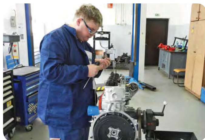
Opravy motorů – seřídít ventily motoru s rozvodem OHV, výfukový ventil 0,2 mm, sací ventil 0,15 mm; provést usazení a nastavení rozdělovače do čtyřválcového motoru
