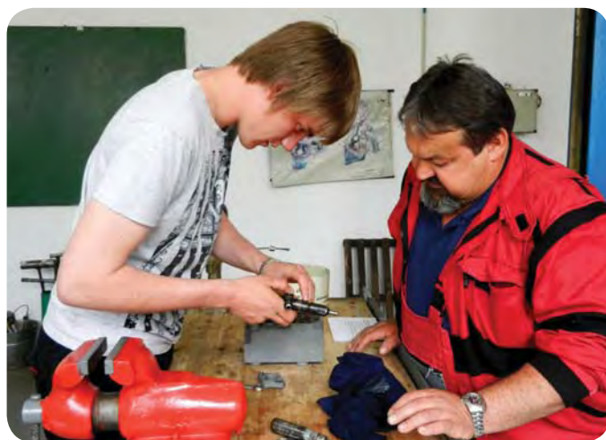
Opravy zemědělských mechanizačních prostředků – demontáž vstřikovače, odzkoušet funkci vstřikovací trysky, vyměnit vstřikovací trysku, seřídít vstřikovací tlak na hodnotu 16,5 MPa, zpětná montáž tělesa vstřikovače do přiložené hlavy
